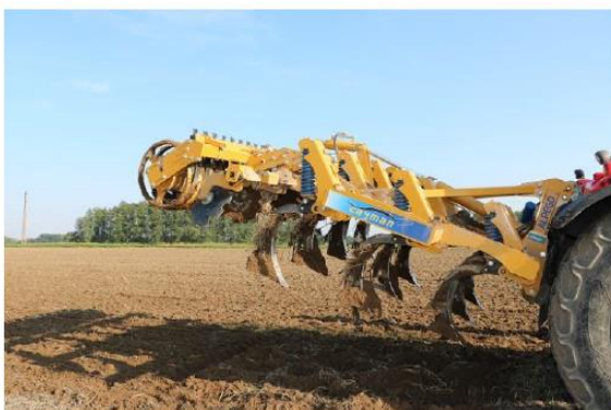
Eine der Bodenbearbeitungsmaschinen auf dem landwirtschaftlichen Betrieb: Grubber Alpego Cayman.
